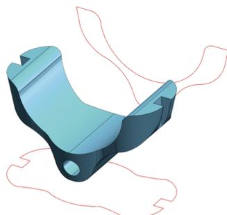
Aus nahezu beliebigen 3D-Modellen (Flächen und Solids) können direkt und ohne Aufbereitung erodierbare Mantelflächen im Definitionstreifen als Regelfläche abgenommen und bei Bedarf auf Körperhöhe verlängert werden. Löcher werden überspannt, Täler auf virtuell verlängerten Mantelflächen überbrückt.
