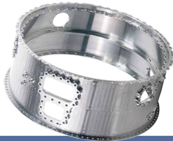
Die Bearbeitung von anspruchsvollen Geometrien mit tiefen Kavitäten, hohen, steilen Wänden und Hinterschnitten erfordert in genau abzugrenzenden Fräsbereichen viele verschiedene Werkzeuganstellungen, die mit einer 5Achs-Bearbeitung kollisions sicher realisiert werden können. Je nach Geometrie und Maschinenkinematik kann zwischen einer 5Achs-Bearbeitung mit Festanstellung, automatischem Indexieren und einer echten Simultanbearbeitung gewählt werden.
