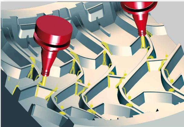
Das automatische Indexieren „automatisiert“ die Programmierung des 3+2-Fräsen und bildet eine Alternative zur 5Achs-Simultanbearbeitung. Diese Strategie sucht für einzelne Fräsbereiche und/oder Werkzeugbahnen selbstständig kollisionsfreie, feste Werkzeuganstellungen, die dann durch eine 5Achs-Simultanbewegung miteinander verbunden werden. Damit lassen sich Bereiche, für deren Bearbeitung mehrere Werkzeuganstellungen notwendig sind, in einer Operation programmieren und fräsen.
